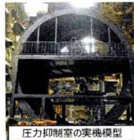
圧力抑制室の実機模型
