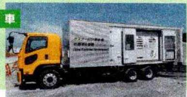
発電機の出力を制御する装置などを搭載。発電機とともに起動し、出力の調整などを行う
