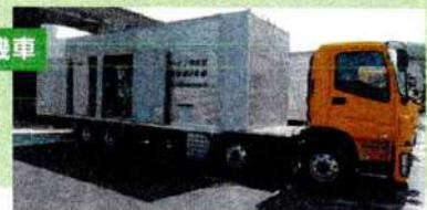
ガスタービンと発電機を搭載。1台あたりの出力は3,600kWで、2台運転することで発電所の安全確保に必要な電力を供給可能
