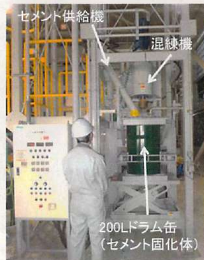
セメント固化設備の工学規模試験装置の外観
