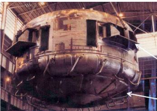
写真1 高放射性廃液タンク 第2回ヒヤリング資料17頁
