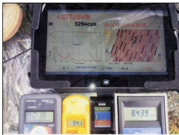
右 車載サーベイメーターの空間線量と地表計測値との比較(双葉町)
